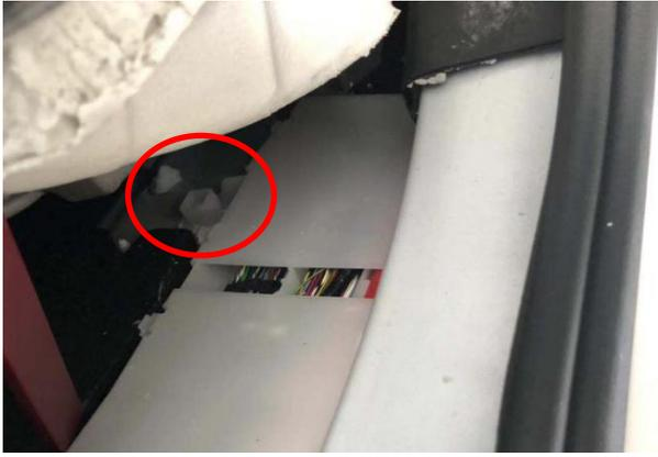
右踏板电机穿线孔：使用撬板撬开线槽卡扣，把线槽拉起方便穿线（红圈）；左右两边踏板电机穿线孔方法一致；
