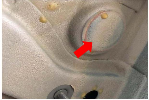
右踏板电机穿线孔：电机线由此孔穿过，**注意不要损伤车身内部的线槽**；左右两边踏板电机穿线孔方法一致；
