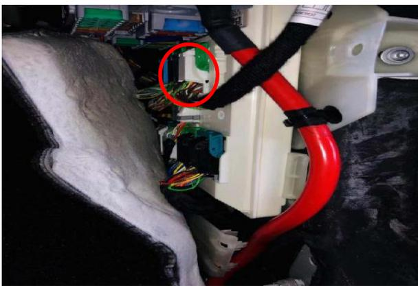
接信号线：在副驾 A 柱内侧板内找到信号线插头（红圈）；
